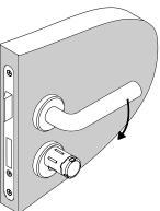
Die Zeit, in der das elektronische Türschloss eingekuppelt bleibt, lässt sich mit der lockzz Verwaltungssoftware einstellen (1 bis 15 Sekunden, der Standardwert liegt bei 5 Sekunden). Nach einer erfolgreichen Berechtigung (Einkuppeln) am elektronischen Türschloss läuft die eingestellte Kupplungszeit ab.
