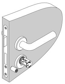
▶ Die Knaufhülle bis zum Anschlag so auf den Knauf aufschieben, dass die markierte Stelle auf der Knaufhülle mit dem vorstehenden Kunststoffteil auf dem Knauf fluchtet.
