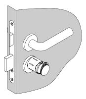
Das elektronische Türschloss ist nun eingekuppelt, die Tür kann durch Drehen des elektronischen Knaufmoduls ver- und entriegelt werden.
