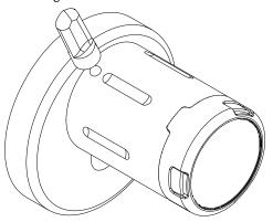
Mit aufgesetztem Batteriewechselwerkzeug die Knaufhülle abziehen.
