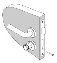
Schließzylinder mit Elektronikknauf aus dem Schloss herausziehen.
